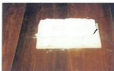
Figura 3.8. Rompimento do tijolo de solo-cimento.
