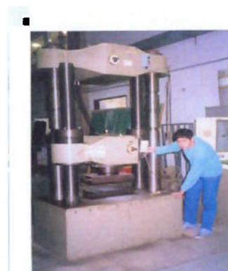
Figura 3.10. Equipamento usado para rompimento dos blocos.
