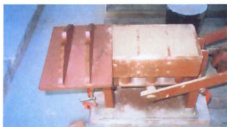
Figura 3.6. Fotos da prensa usada para confecção dos corpos de prova.
